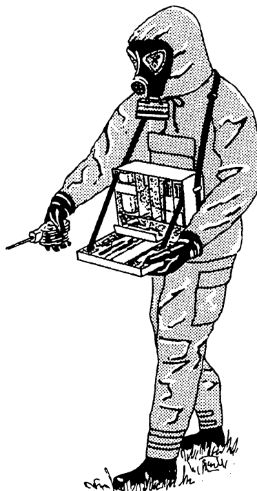
Spüren mit Prüfröhrchen und Spürpumpe
