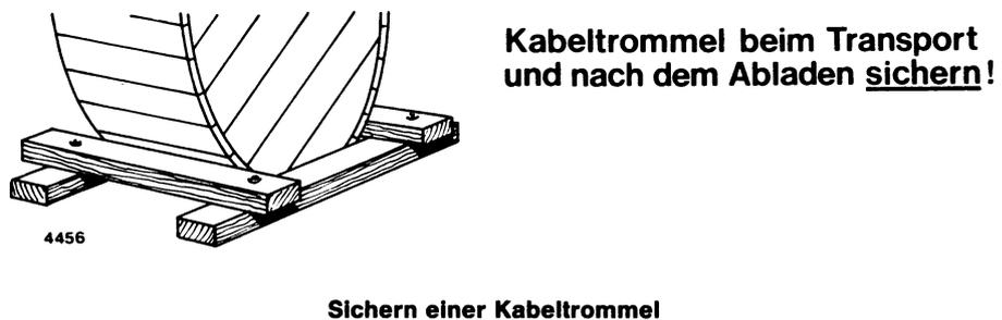
Das Abwerfen von (auch leeren) Kabeltrommeln oder von Kabelringen vom Transportwagen ist unzulässig, da hierdurch leicht Kabelbeschädigungen und Unfälle entstehen können. Kabelringe sollen nicht stehend gelagert oder transportiert werden. Der Transport auf Baustellen sollte mittels eines Kabeltrommelhebe- und Transportgeräts oder auf Handwagen (Plattformwagen) erfolgen.
